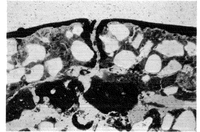
Fig. 4. Top af forvitningsområde. Øverst ses tæt, mørkt lag af oliemaling, der løber ind i revner i mørtlen. De mørke partikler i mørtlen er slagge. Hulrum opstået ved forvitring er udfyldt med rødfarvet araldit. Gennemfaldende lys, parallelle nicol'er. Forstørrelse 32 \times .
